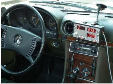
**SOLUTION 2** : Fixation du trip avec bouchon de fixation (fixation par colle et/ou vis). Les matériaux utilisés sont en ABS.
